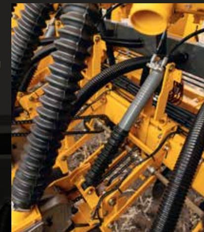
Actuador de doble cámara, una neumática de presión regulable que imprime una fuerza constante sobre el cuerpo de siembra. A diferencia de sistemas similares, el TWIN FORCE cuenta con otra cámara hidráulica que otorga amortiguación controlando y estabilizando oscilaciones del cuerpo de siembra, esto permite sembrar en terrenos desparejos, un 20% más rápido en cualquier condición (\*).
