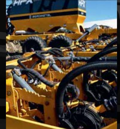
Actuador de doble cámara, una neumática de presión regulable que imprime una fuerza constante sobre el cuerpo de siembra. A diferencia de sistemas similares, el TWIN FORCE cuenta con otra cámara hidráulica que otorga amortiguación controlando y estabilizando oscilaciones del cuerpo de siembra. Esto permite sembrar en terrenos desparejos y en cualquier condición un 25% más rápido (\*).
